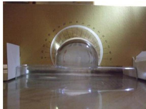
図8. 40度で入射した発光ダイオードの光が底面で反射し、焦点を結ぶ様子
